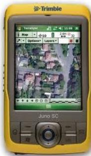
گیرنده GPS مدل **Juno SC** کامپیوترا صحرائی سبک و مقوون به صرفه ایست که شامل چندین خصوصیات ممتاز است. امکان عکاسی دیجیتال، انتقال اطلاعات با مودم **GSM** و گیرنده **GPS** دقیق آن که دقت آنی آن 2 الی 5 متر و دقت پس پردازش آن 1 الی 3 متر است از جمله این ویژگی ها هستند.
