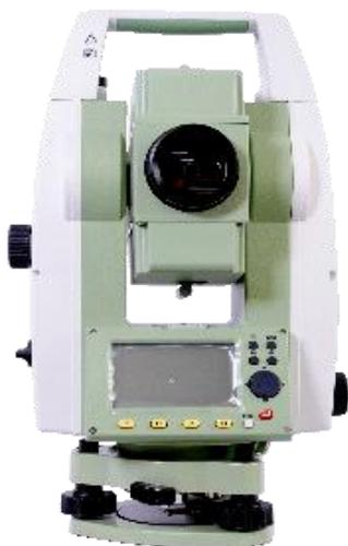
سافت سوئیس ، دقت اندازه گیری 5 ثانیه ، دارای کمپانساتور دو محور ، کیرد در یک طرف ، صفحه نمایش مرفی و عددی ، 100% ضد آب ، توانائی اندازه گیری اشیاء بدون نیاز به منشور به صورت مستقیم تا فاصله 400 متری ، دارای پورت تغلیه اطلاعات USB
