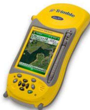
برای جمع آوری اطلاعات بسیار دقیق GIS دستگاہ GeoXM از سری Geoexplorer3000 قابل تهیه می باشد. با GPS دستی GeoXM این گروه می تواند محل اشیاء را با اطمینان خاطر تا دقت 1 الی 3 متر و با کارآئی بالا در جریان کاری برداشت نماید.
