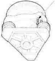
پیچ تنظیم تراز استوانه‌ای
