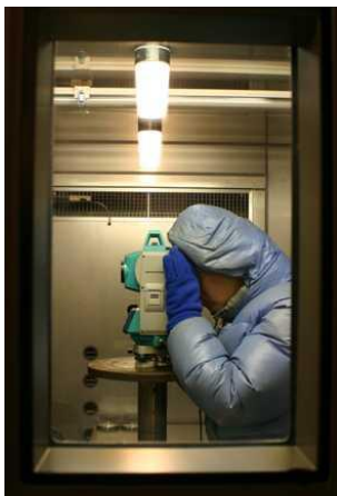
بررسی دوربین تحت درجه حرارت پایین در اتاق آزمایش
